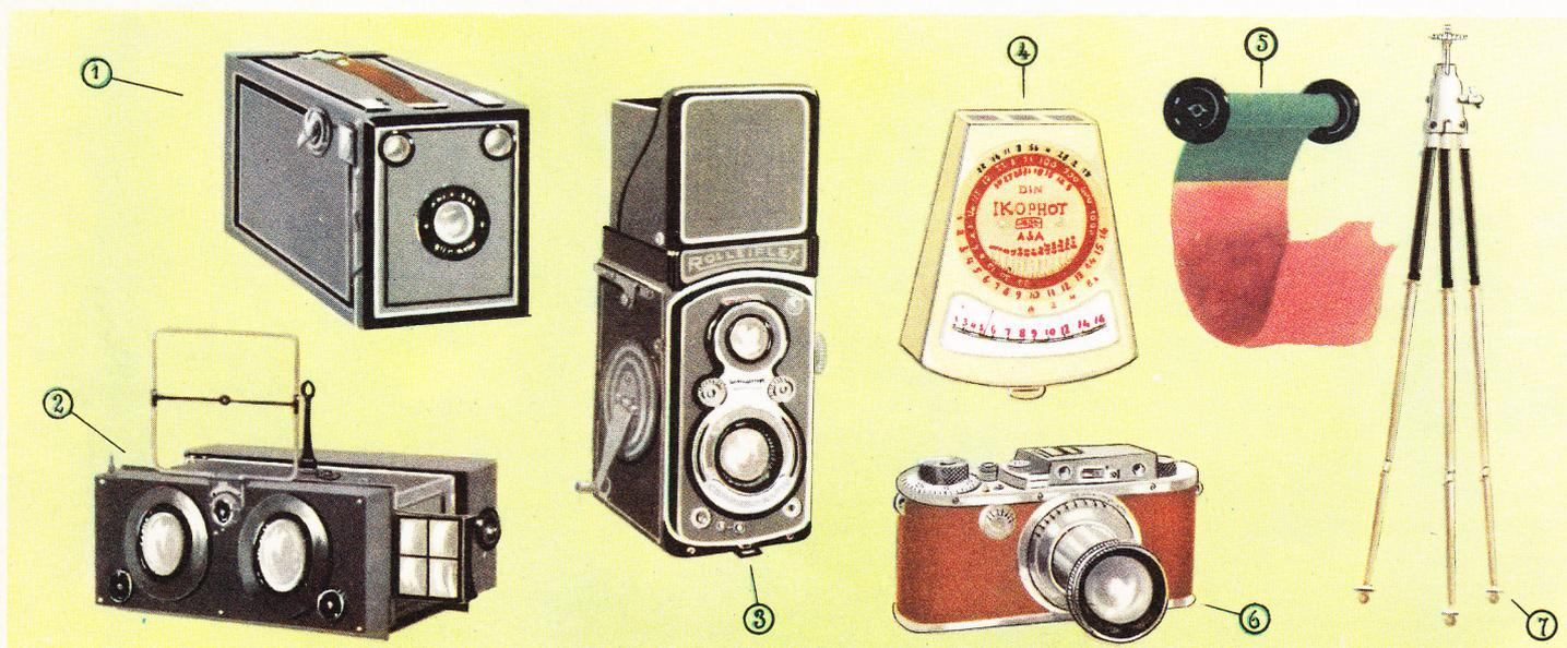
Quelques types d'appareils et d'accessoires: 1) Box (appareil à boîte). 2) Appareil stéréoscopique. 3) Rolleiflex à deux objectifs. 4) Cellule photoélectrique (posomètre). 5) Rouleau de pellicule. 6) Appareil du type Leica. 7) Trépied.
